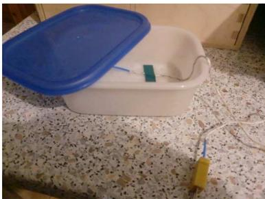
Abb 1 : Kunststoffbehältnis mit mittig fixiertem Thermofühler
