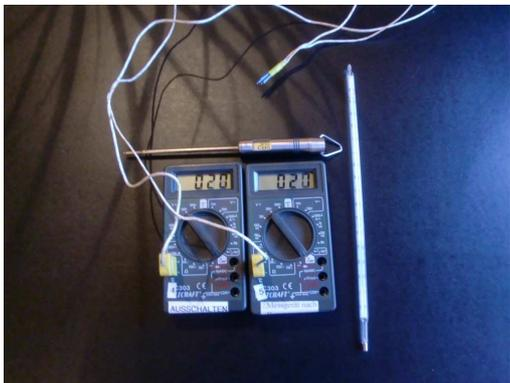
Abb. 2: Thermofühler, Quecksilberthermometer, Digitalthermometer
