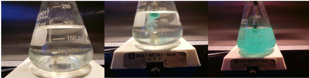
Abb. 2: Im unbewegten Wasser verteilt sich der Farbstoff ungleichmäßig und langsam
