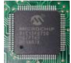
Abb. 1: PIC im TQFP-Gehäuse mit 80 Pins in Originalgröße
